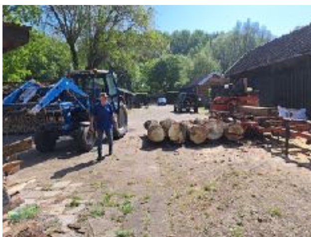
Eén dag per jaar komt de gehuurde zaagmachine om eiken schaaldelen te zagen (voor de timmerwerkplaats)
